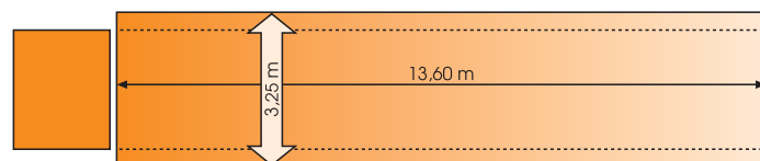
Quer teleskopiertes Dach - bis 34 t NL über Andockachse, bis 3,25 m breit im Fahrbetrieb
